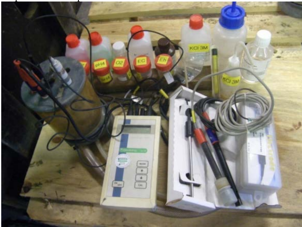
Figuur 2.7 Veldmeetset voor watermetingen
