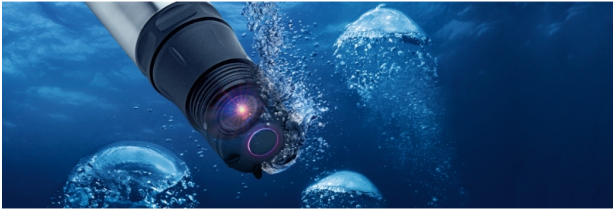
Figuur 3.8 Zuurstofmetingen vinden plaats aan een gevoelig membraan
