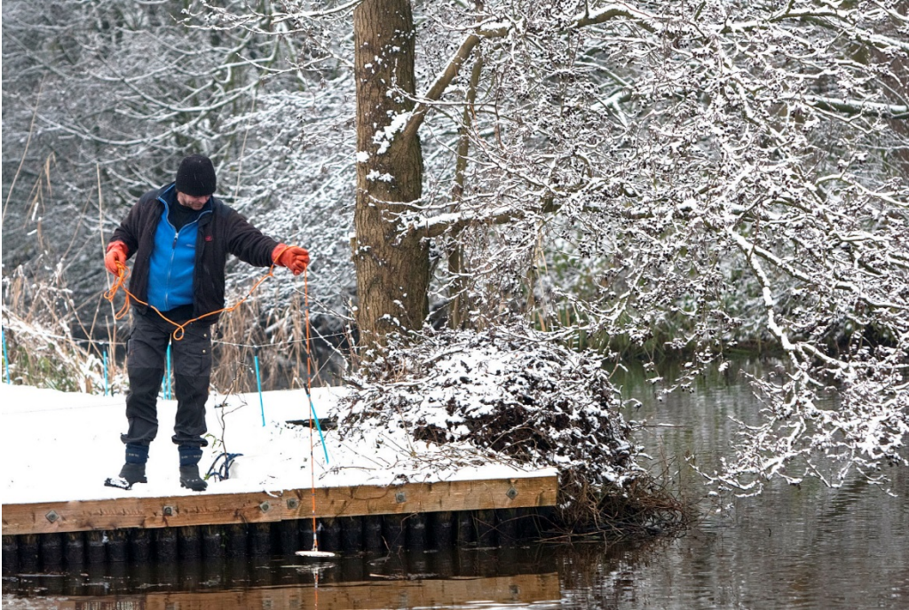
Figuur 2.5 Doorzichtmeting met de Secchi schijf
