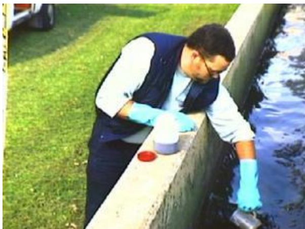
Figuur 3.14 Steekmonster uit open leiding
